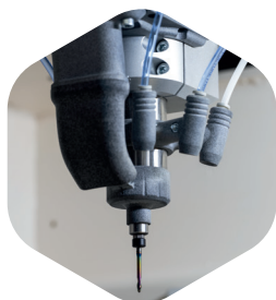
Sistema di lubrificazione
