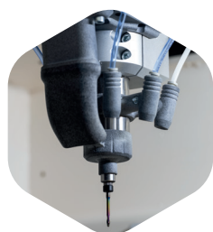
Sistema di lubrificazione
