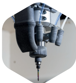
Sistema di lubrificazione
